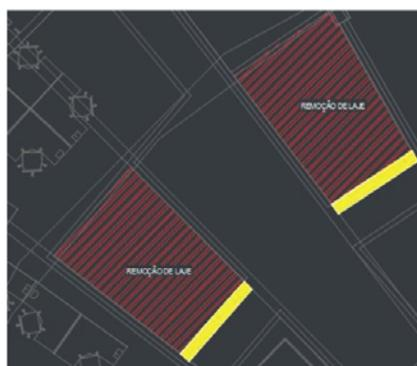
Figura 10 – Local de remoção das lajes
