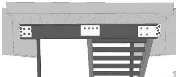
Figura 09 – Detalhe fixação viga
