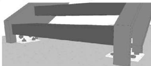
Figura 16 – Fixação escada na laje térreo
